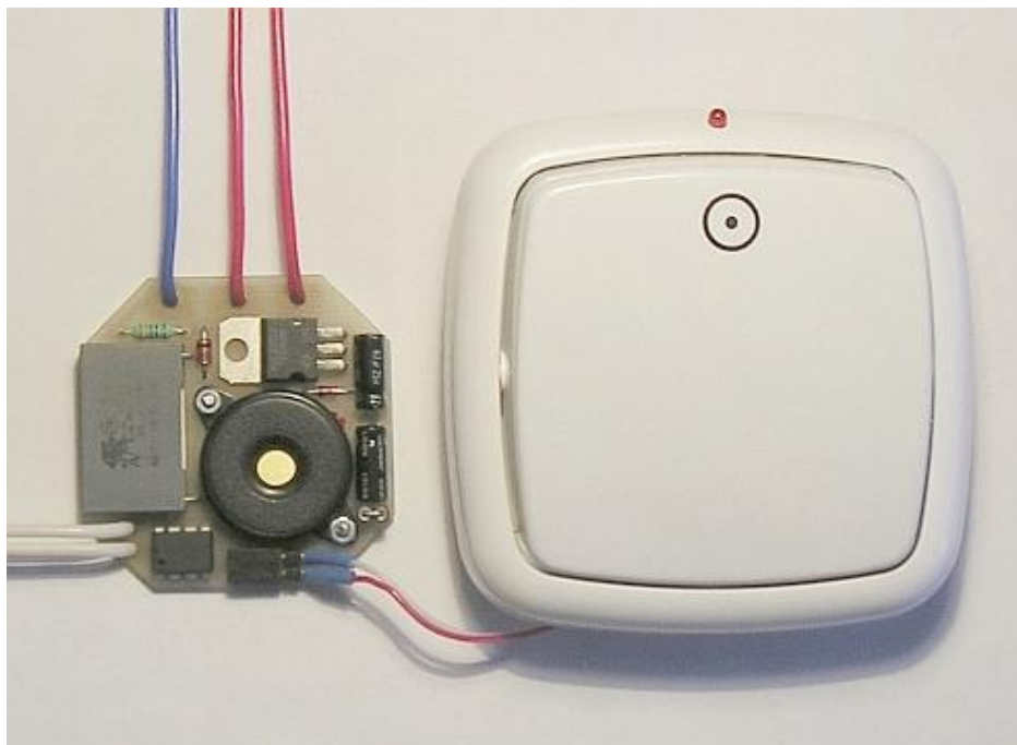
Obr. 9. Príklad umiestnenia LED na rámčeku spínača
